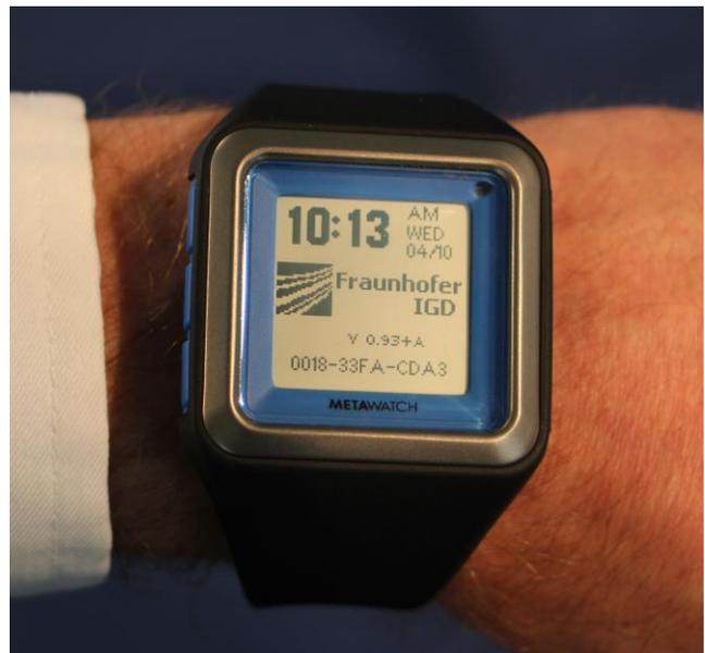
**Abbildung 1: Wasserdichte Smartwatch mit integriertem Beschleunigungs- und Lichtsensor, Vibrationsmotor, Funkmodul und Matrixdisplay**
