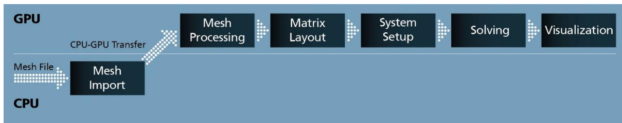
Abbildung 1: Übersicht der Berechnungen, die auf der CPU und GPU ausgeführt werden.
